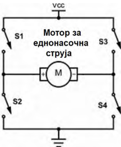
Слика 4.43. Принцип на работа на Н-мост
