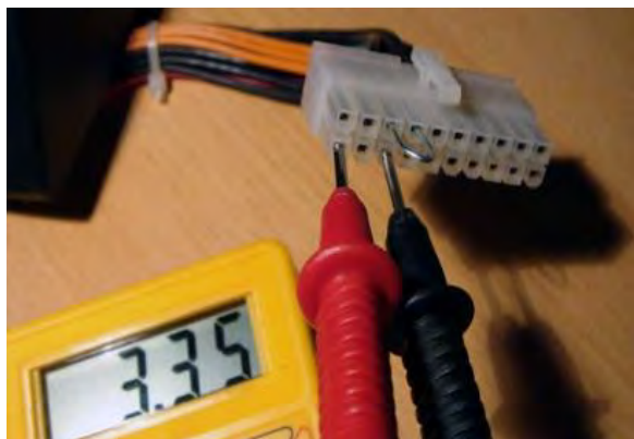
Слика 2.11.Проверка на напон на излезни пинови на кабел за напојување АТХ (20+4)
