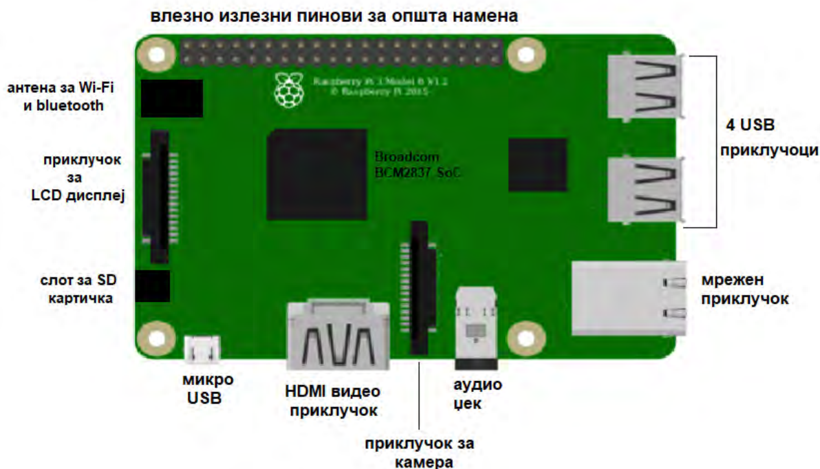
Слика 4.27. Составни делови на Raspberry Pi 3B+ (поглед од горе)
