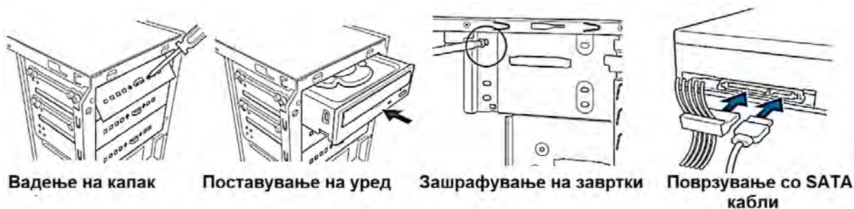
Слика 2.13. Инсталација на оптички уред
