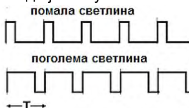
Слика 4.41. Зависност на интензитетот на светлина од ширината на импулсите
